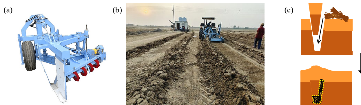
図1 (a)カッター、(b)カッターによる浅層暗渠の施工風景、(c)浅層暗渠施工の模式図
