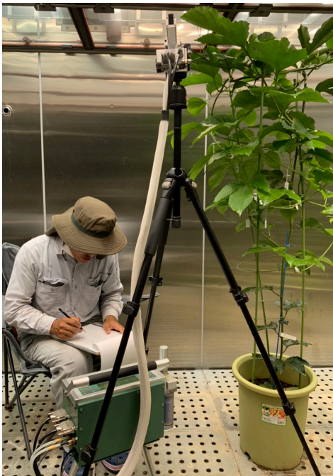
図1 人工気象室内での光合成測定
