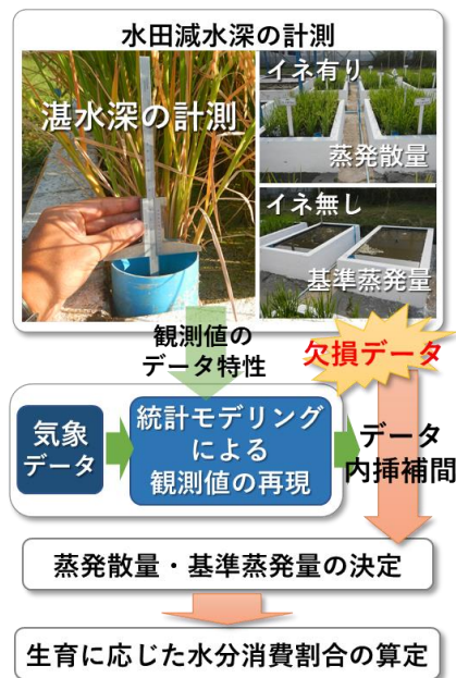
図1 水分消費割合の算定手順 イネ有無しタンク内の日減水深を蒸発散量、基準蒸発量とする。気象データは正味放射量、気温、湿度、風速。
