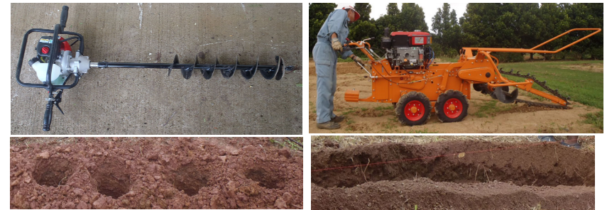
図1 部分耕として使用する携帯型深穴掘り器(左)と深溝掘り機(右)
