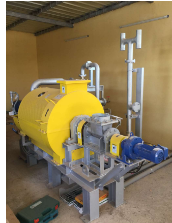
図3 焼成処理に利用する外熱式Uターンキルン (ブルキナファソ、INERA-カンボアンセ支所)
