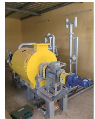
図 3 焼成処理に利用する外熱式 U ターンキルン (ブルキナファソ、INERA-カンボアンセ支所)
