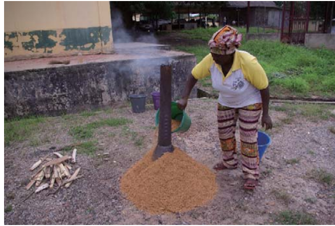
Fig. 1. Charring of saw dust (Kumasi City)
