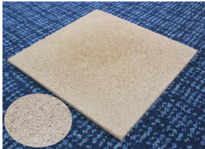
図1 幹粉末が原料のバインダーレスパーティクルボード(円内は表面の拡大)
