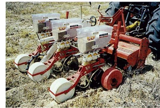
図1 不耕起播種(試作)機
