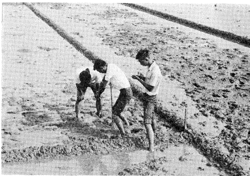
写真1 湛水中の地耐力測定
