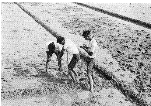
写真1 湛水中の地耐力測定
