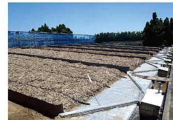
畠地の土壤流出実験に使用する熱研施設の人工傾斜圃場
