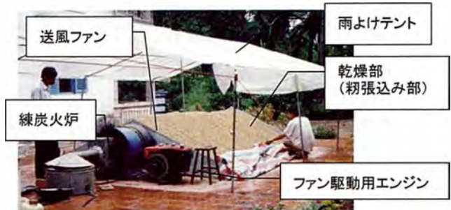
図 1 テントハウス型乾燥機の外観と主な仕様
