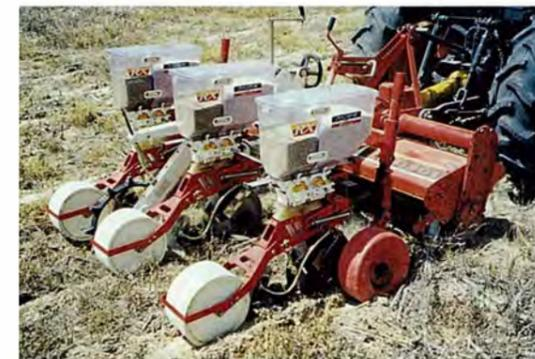
図1 不耕起播種(試作)機
