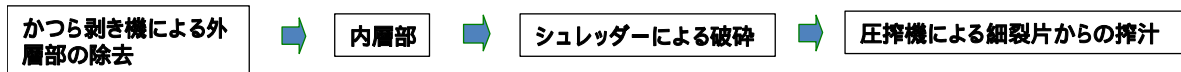
図1 オイルパーム廃棄木からの樹液搾汁システムの構成及び搾汁プロセス
