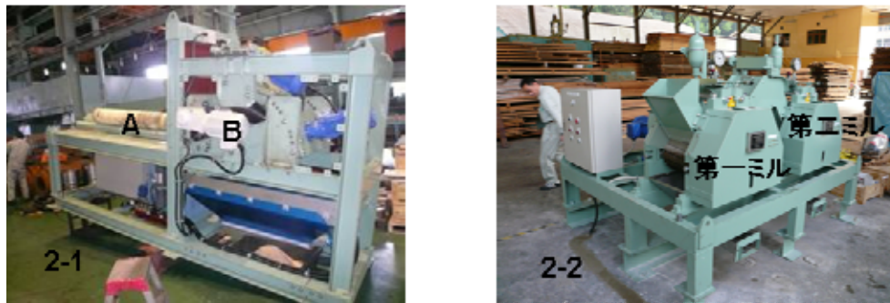
図2 内層部(パームトランクコア)を細裂片にまで破碎するシュレッダー(2-1)と細裂片から樹液を搾汁する圧搾ミル(2-2)
