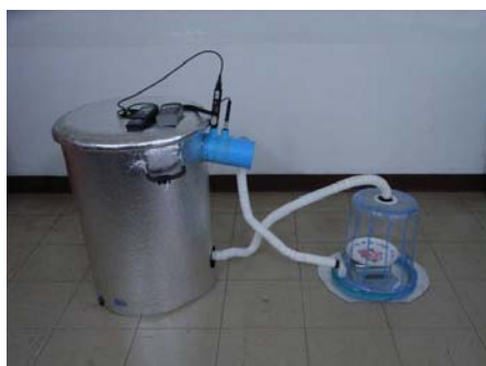
図3 光合成蒸散測定装置の組み立て例と測定精度検定の様子、および検定結果と測定例
