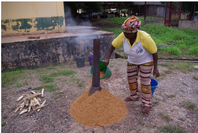
Fig. 1. Charring of saw dust (Kumasi City)
