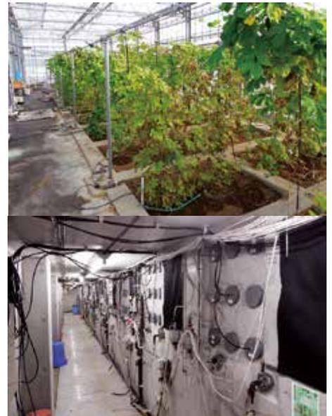
図 1 根圏調査と養水分収支を実測できるライシメーター（地上部、地下部）
