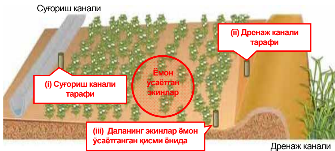
2.1.2-расм. Назорат қудуғини ўрнатиш учун тавсия қилинадиган жойлар
