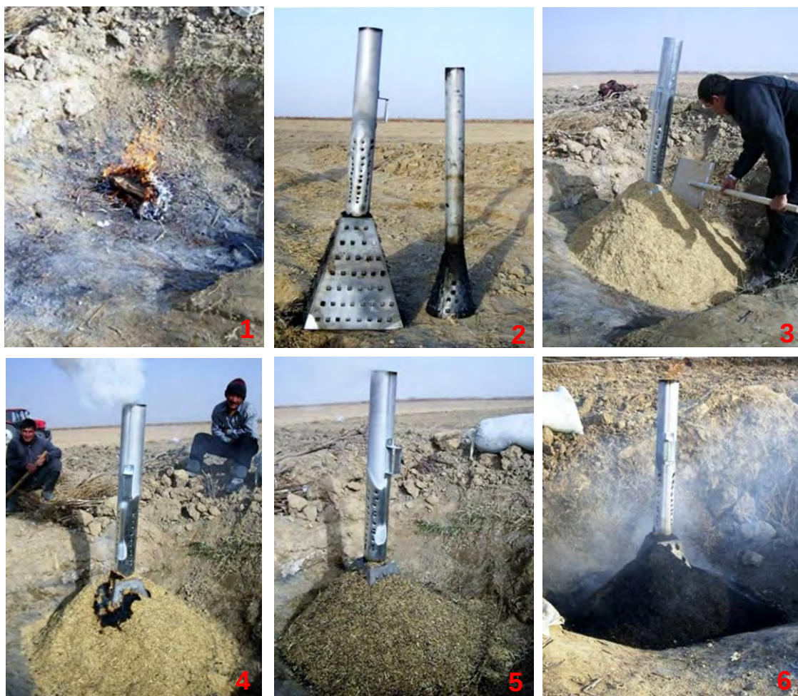
2.5.11-расм. Шоли кепадигдан писта кўмир тайёрлаш (японларнинг ананавий усули)
