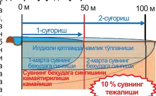
2.2.2-расм. Импульсли (дискрет усулда) суғоришда сувнинг беҳудага сингишининг концептуал схемаси
