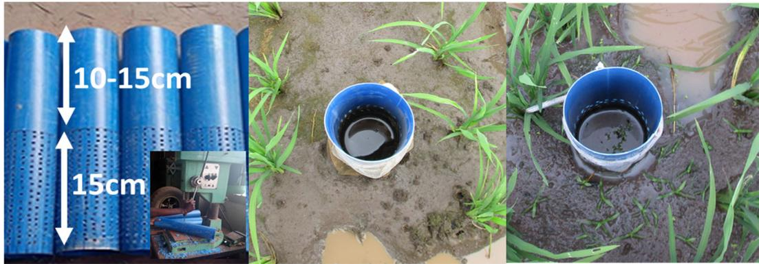
写真 7.2 穴あきパイプの例（左）；穴あきパイプによる地下湛水面の様子（中央、右）
