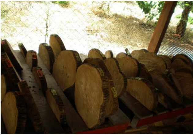
写真 4.1 輪切り試料の乾燥
