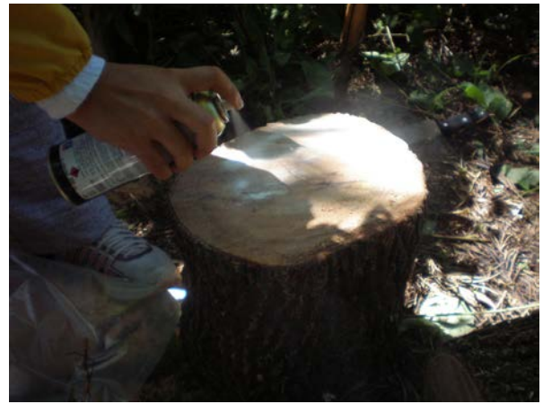
写真 3.6: 輪切り試料両面へのコーティング
