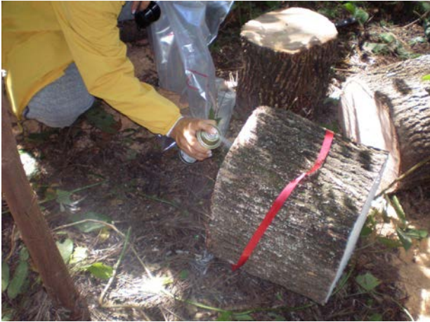
写真 3.5: 輪切り試料両面へのコーティング
