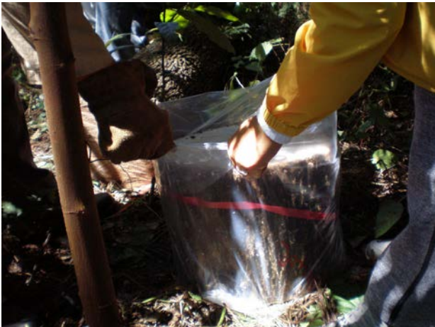
写真 3.7: 試料のプラスチック袋への詰め込み
