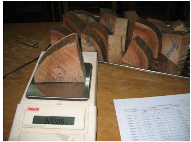
写真 3.12: 試料の乾燥重量の計測
