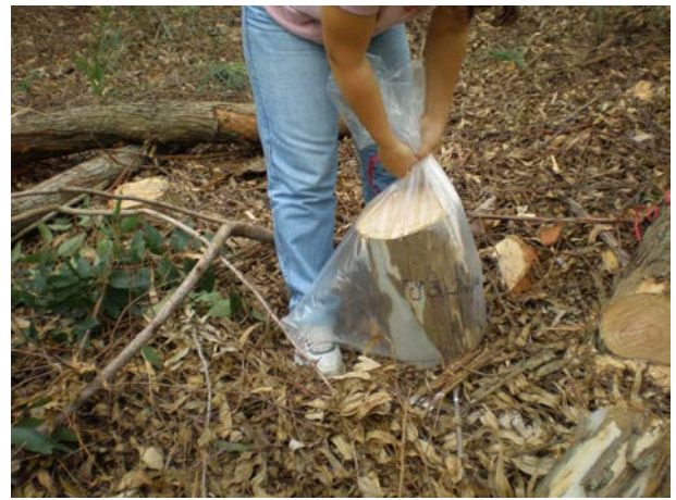
写真 3.8: 試料のプラスチック袋への詰め込み
