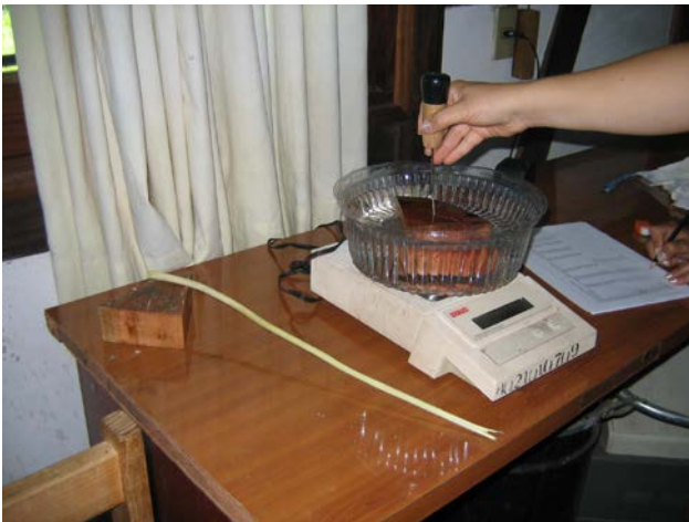
写真 3.9: 試料の容積の計測
