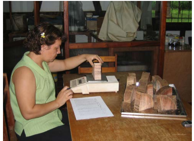
写真 3.10: 生木の重量の計測
