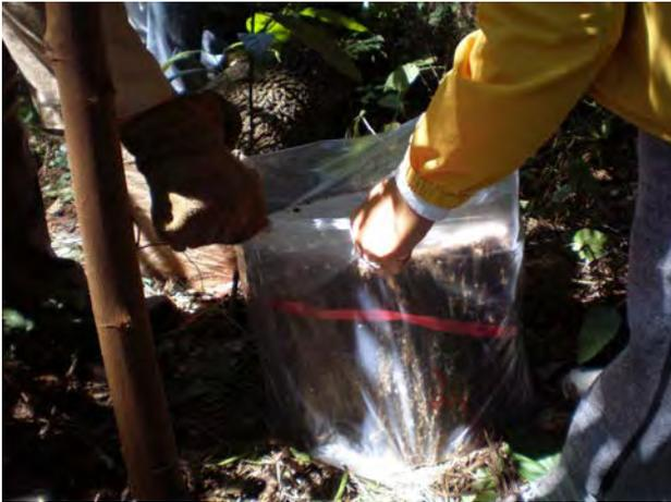
**Fotografía 3.7 Colocación de muestras de madera en bolsas de plástico.**
