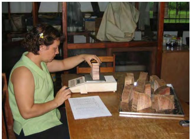
**Fotografía 3.10 Determinación del peso de las probetas en estado verde.**
