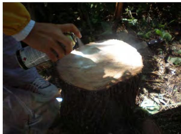
**Fotografía 3.6 Sellado de los extremos de trozas con pintura.**
