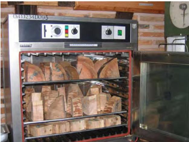
**Fotografía 3.11 Secado al horno de las probetas.**
