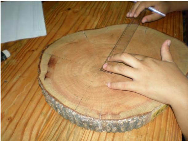
**Fotografía 4.5 Medición de los radios, CIF/UNA**
