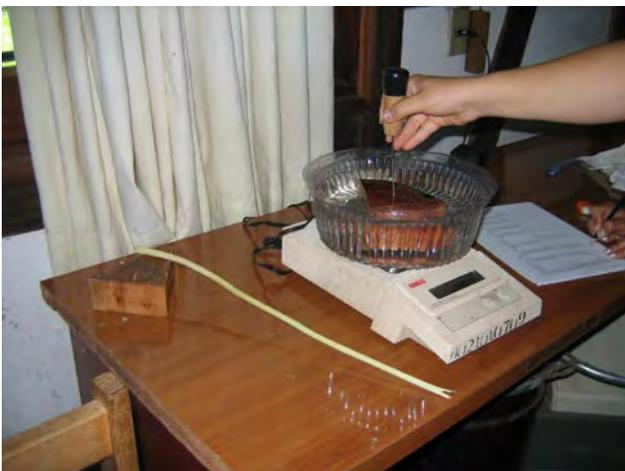
**Fotografía 3.9 Determinación del volumen de las probetas.**
