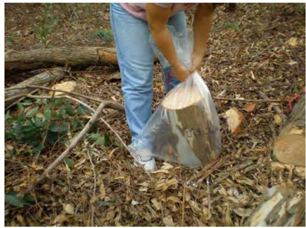
**Fotografía 3.8 Colocación de muestras de madera en bolsas de plástico.**
