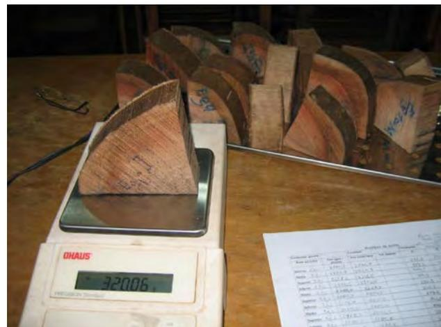
**Fotografía 3.12 Determinación del peso seco de las probetas.**
