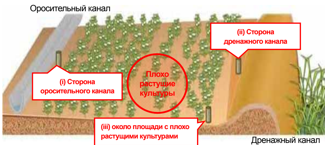
Рис. 2.1.2 Рекомендуемые пункты для установки наблюдательных колодцев
