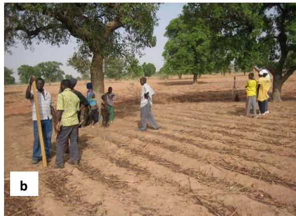
Photo 1 : Utilisation du niveau à eau pour déterminer les courbes de niveau
