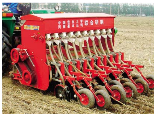
図2 中国で開発された部分耕起播種機（トウモロコシ残渣の中に小麦を播種することが可能）
