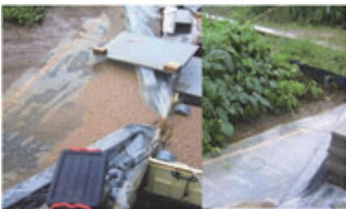
図2 傾斜圃場の各プロットから土壌流出量を測定している様子
