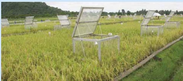
図2 使用した温室効果ガスの排出・吸収の観測装置
