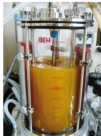
写真2 伐採オイルパーム幹の樹液を使った発酵試験
