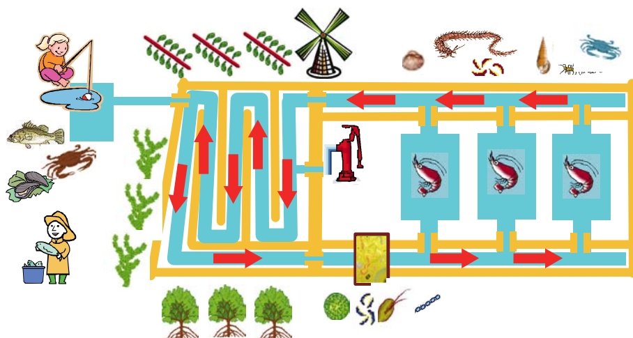
図1 底生生物、プランクトン、マングローブ、海藻等の生態機能を利用した環境に優しい循環型エビ養殖システム
