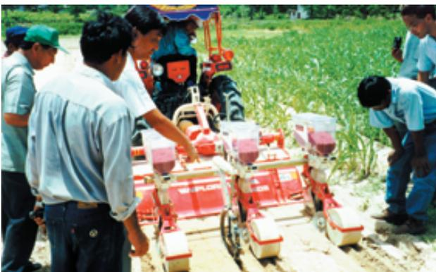
化を促す、5) サブソイラーと施肥・植付機を結合した部分深耕同時施肥・植付機を開発し、これにより、サトウキビの耕起から植付けまでの作業工程を簡略化でき、耕起・植付作業の燃料消費量・作業時間を削減できる、等が挙げられる。
