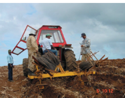
サトウキビ畑における点滴チューブの設置作業。モータリシャスではサトウキビ畑の約7%で水利用効率の良い地中点滴灌漑が行われている
