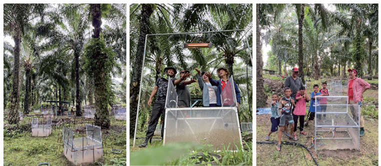
写真2 国立環境研究所の協力のもと、マレーシアのオイルパーム農園内に設置した自動開閉式マルチチャンネルチャンバーシステム。気候変動を模した温暖化操作実験等も実施している。
