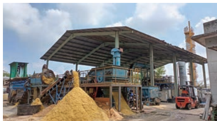
写真1 SATREPS プロジェクトにおける原料マルチ化プロセスの実証試験サイト。多様なバイオマスを高品質なペレットへ変換する技術開発の拠点となりました。ここで製造されたペレットは、日本・マレーシア両国の研究機関や企業に提供され、応用研究に活用されました。
