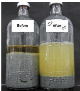
写真1 未処理の廃棄雑誌を使った微生物糖化の様子。微生物自身の酵素系でバイオマスを分解し、糖化液を直接メタン発酵に利用することができます。
