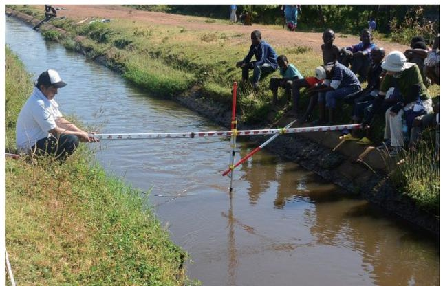
写真2：水路の流速を測定中（タンザニア）
