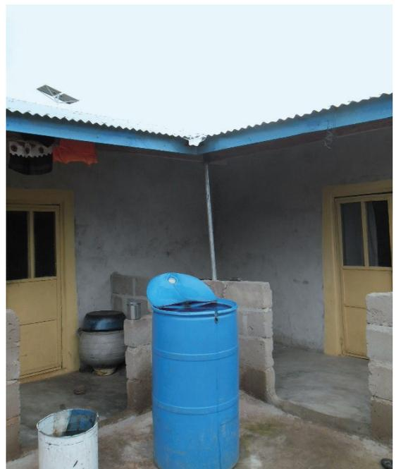
写真2：屋根に降る雨水を容器に貯める
