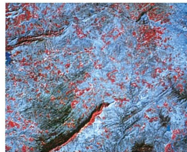
対象地域のフォールスカラー衛星画像 (侵食谷は樹形状に、植生域は赤色で表される)
