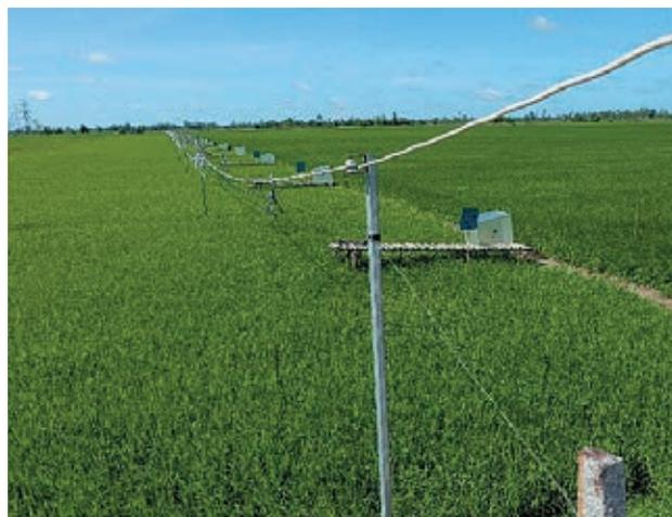
写真2 ベトナムのメコンデルタの水田における温室効果ガス観測システム(水田からの温室効果ガスの発生抑制技術は、目標13「気候変動に具体的な対策を」に貢献)
