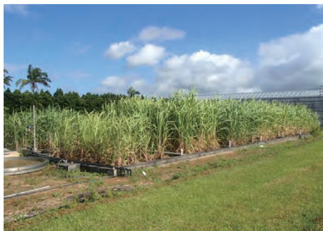
写真 熱帯・島嶼研究拠点（石垣島）のライシメーターを用いたサトウキビ栽培における窒素肥料の溶脱および窒素吸収量の測定
