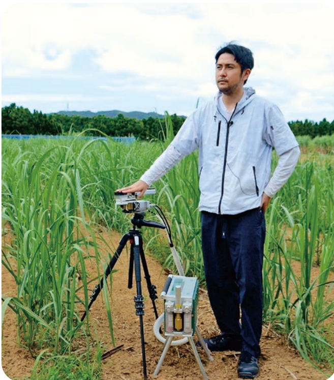
写真2 携帯型装置を使って圃場でガス交換（植物の息遣い）を測定する（植物はサトウキビ）
