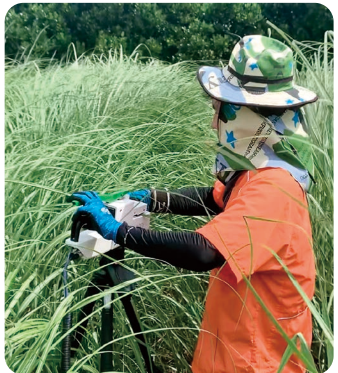
写真2 携帯型装置を使って圃場でガス交換（植物の息遣い）を測定する（植物はサトウキビ）
