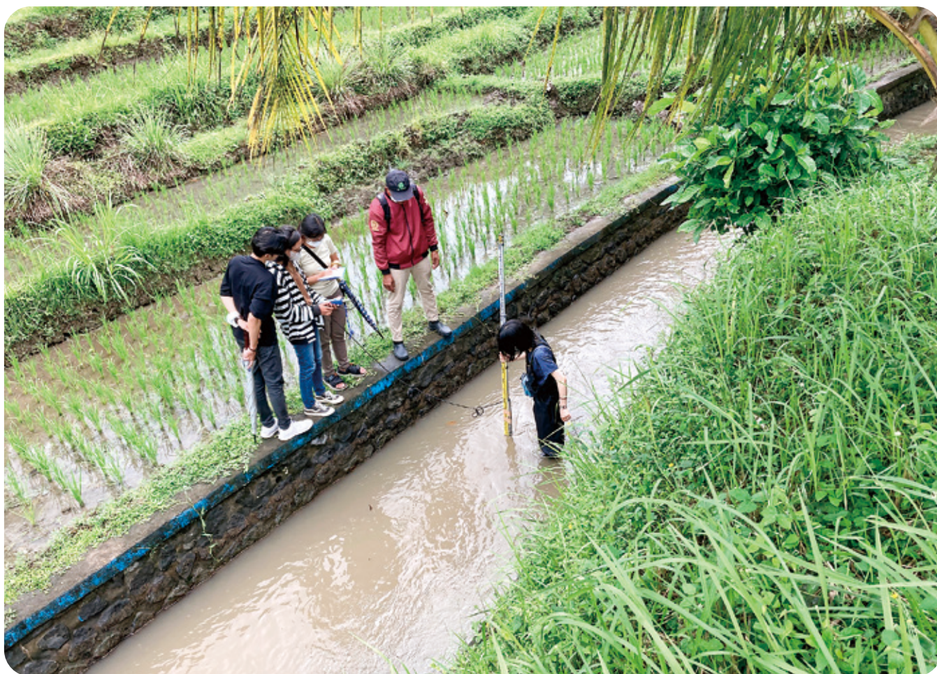
水路内で水位や流速を計測
