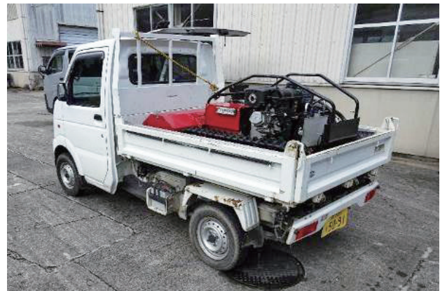
Fig. 3. Loaded onto a mini truck (truck bed size: 1940×1410 mm)
