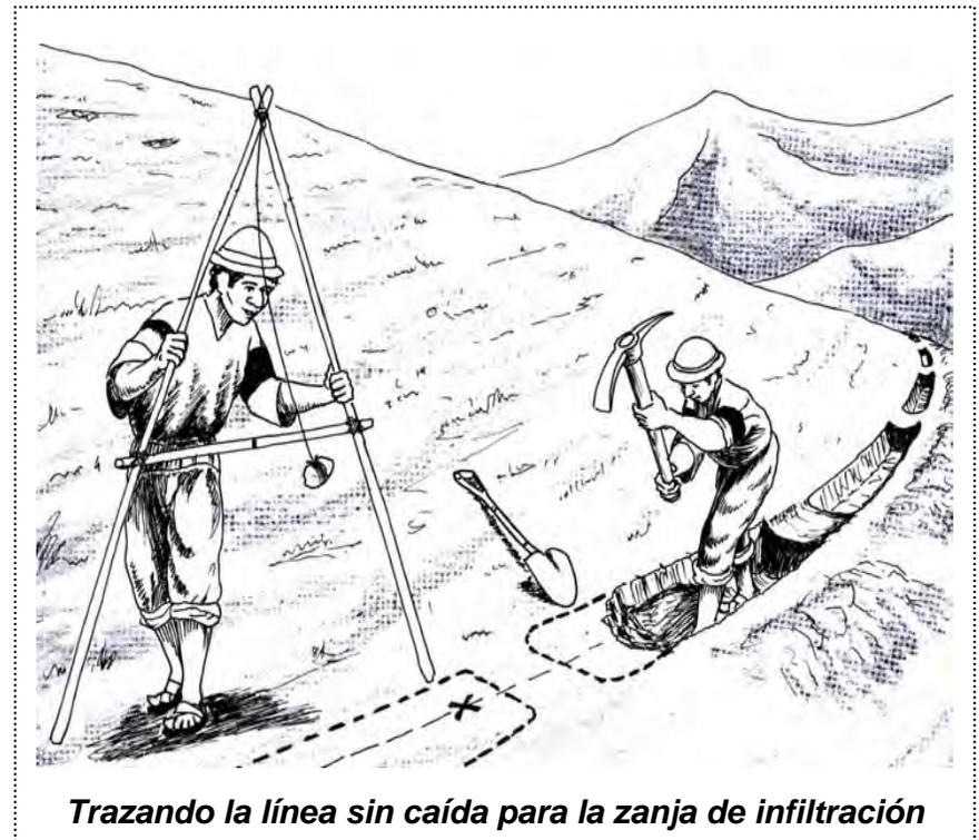
*Trazando la línea sin caída para la zanja de infiltración*
