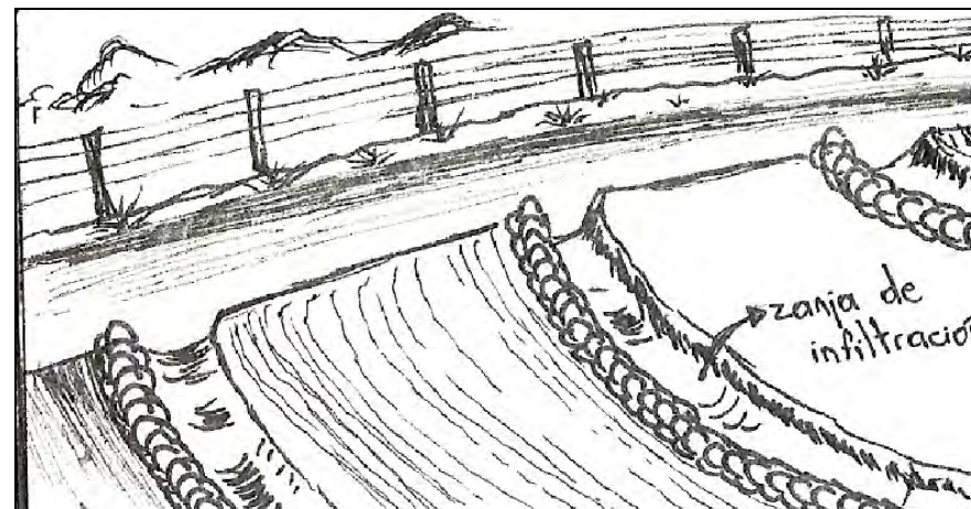
Figura 8. Zanja de infiltración.
