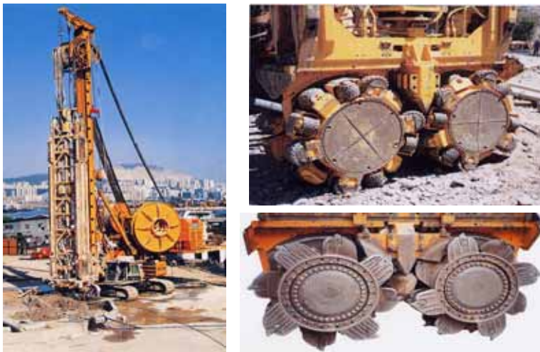
図 4.4.70 BAUER 社製水平 2 軸回転式掘削機 (Trench Cutter)
