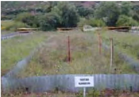
写真 1.3.3 試験 2 年目の雨季終盤 (2001 年 3 月) のプロット B プロット上流側から撮影。プロット内および周辺一面に雑草が既に繁茂し、以後、試験終了までずっとこの被覆状態が維持されていた。10 mm 程度の雨でも土壌流亡はおろか、地表流出すらほとんど発生しなかった。
