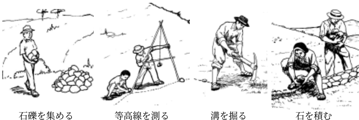
図 2.2.7 石積みの設置手順
