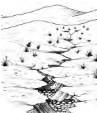
図 2.2.5 石を用いたガリ防止工
