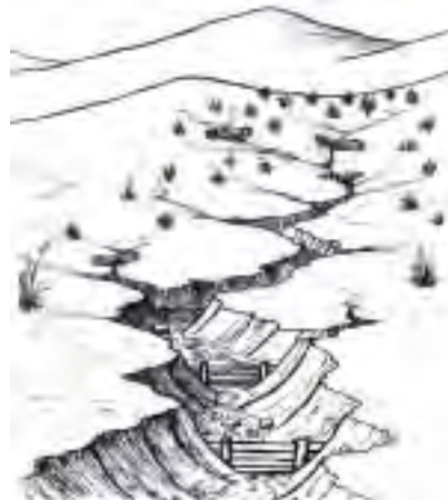
図 2.2.6 木杭によるガリ防止柵
