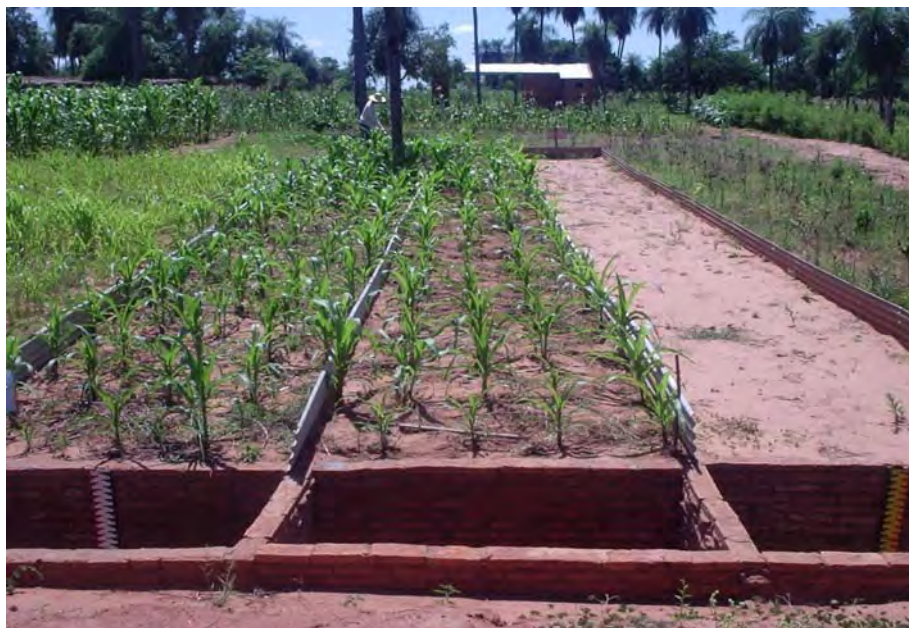
Parcela para medir la erosión del suelo en la PDE del Proyecto J-Green
