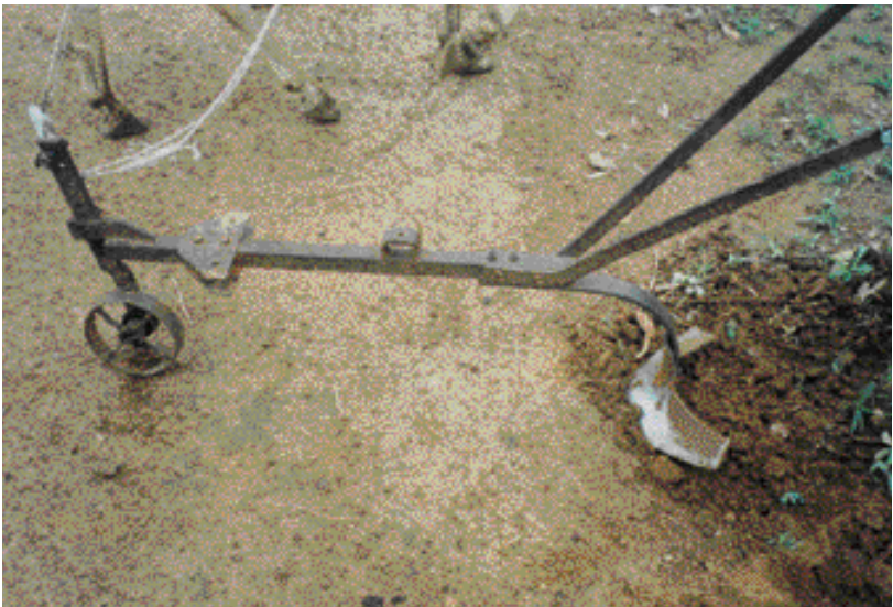
Exemple de charrue utilisée avec les bêtes de somme
