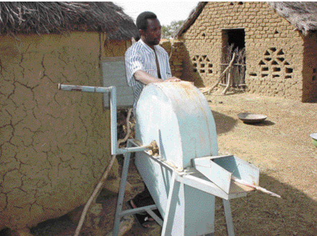
Machine à hacher utilisée pour les tiges de mil
