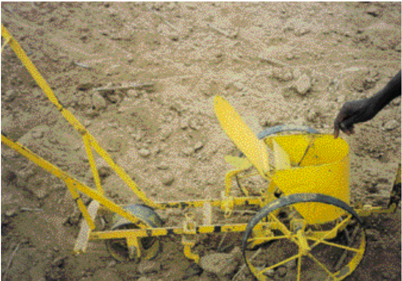
Exemple de machine à semis utilisée avec les bêtes de somme
