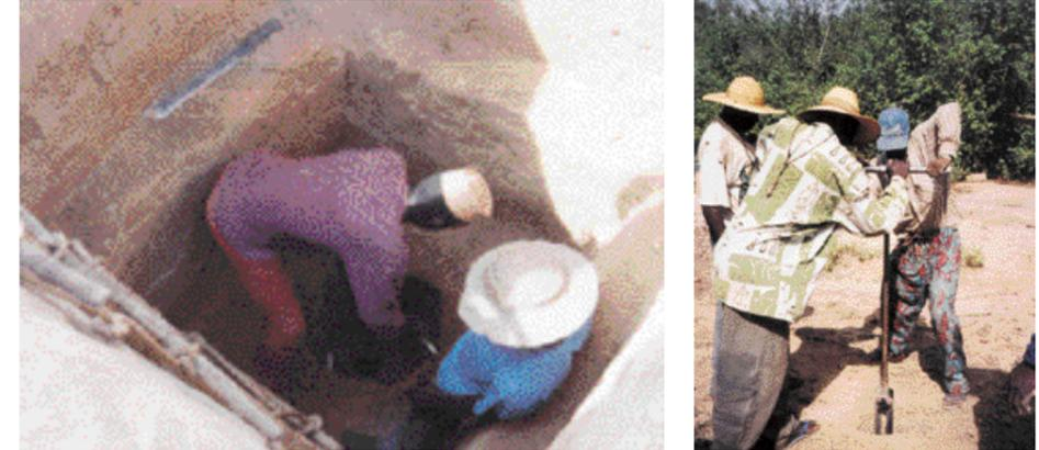
Les carottes et la boue obtenues par creusement seront classées dans un profil stratigraphique comme sur la Figure 3.4.11 par type, grain et couleur.
