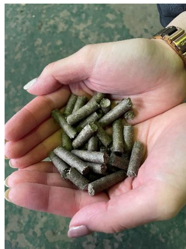
原料マルチ化プロセスで製造したオイルパーム枝葉（OPF）からのペレット（マレーシア）
