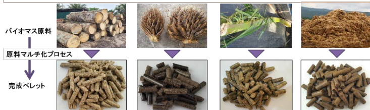
図2 原料マルチ化プロセスで製造された各バイオマスペレット。同一のプロセスで、持続可能で良質なペレット材が製造できる。
