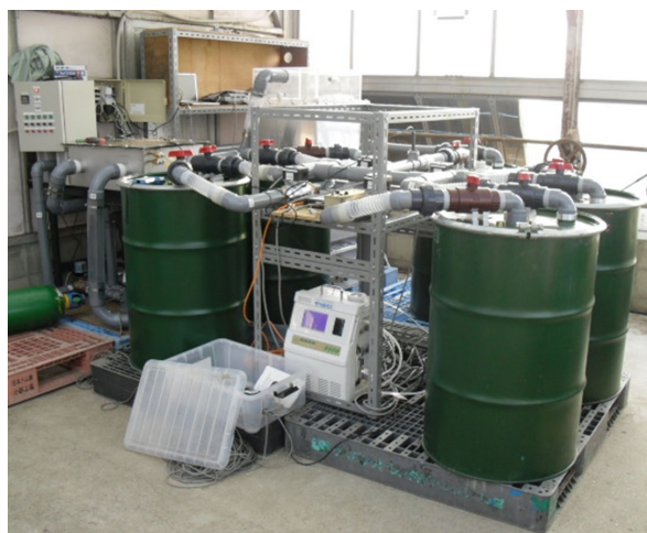
図2 CO 2 回収・施用装置
